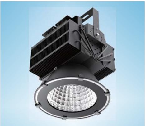
HB100可代替200W-250W传统高压钠灯或金卤灯，安装高度距地面5-7米
