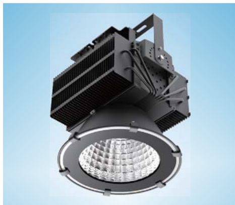
HB120可代替250W-300W传统高压钠灯或金卤灯，安装高度距地面6-8米
